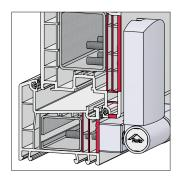
Крепление несущих деталей фурнитуры через 3 стенки ПВХ профилей или дополнительно в металл
